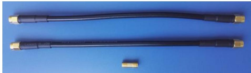
注：传输校准通常需要上图一根或两根 SMA 直通线(两端均为内螺内针，在满足测试条件下，越短越好)和一个直通转接头(两端均为外螺内孔)，当然可能还需衰减器、其他 SMA 转接头)，所有非目标测试件上的其它配件(其它配件越少越好)，均要加入到校准中做校准去除，常用于传输（S21）校准(主要是用于器件的传输测量, 因 miniVNA Tiny 的动态性能不够，不适合用于双工器的测试)，[上图中配件同样需用户自行购买](#)。
