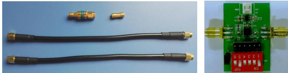
**注:** 测试放大器时务必小心, 需要级接跟放大器相近倍数的衰减器! 示例使用 40dB 的固定衰减器(或其他 1dB、2dB…20dB…), 也可以选用上图(右)中的可变衰减器或其他衰减器!
