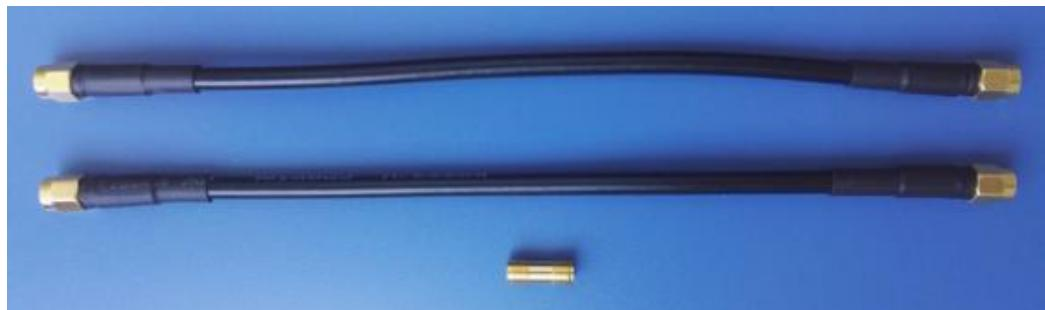
注：上图两根 SMA 直通线（两端均为内螺内针，在满足测试条件下，越短越好）和一个直通转接头（两端均为外螺内孔）。
