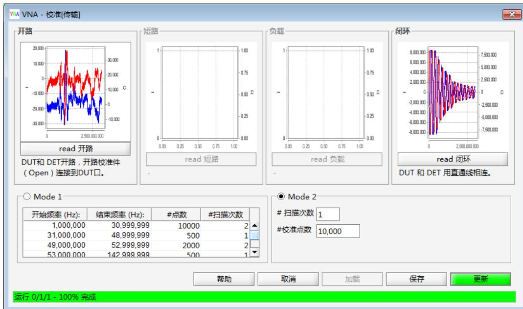
注：上图中开路和闭环校准曲线每一台 minVNA Tiny 都有区别，加入不同的配件测量时也不相同，上图仅供参考。
