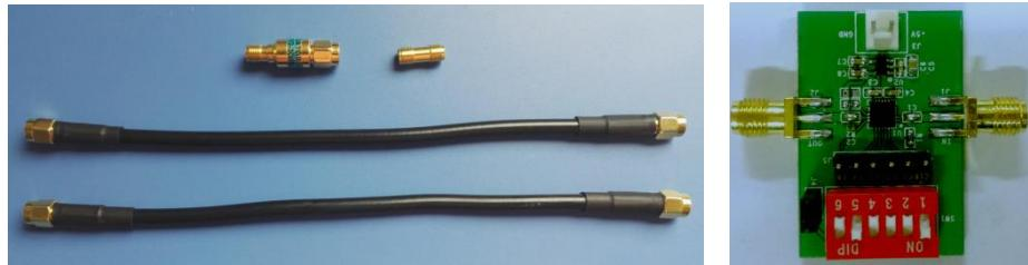
**注:** 测试放大器时务必小心, 需要级接跟放大器相近倍数的衰减器! 示例使用 30dB 的固定衰减器(或其他 1dB、2dB…20dB…), 也可以选用上图(右)中的可变衰减器或其他衰减器!
