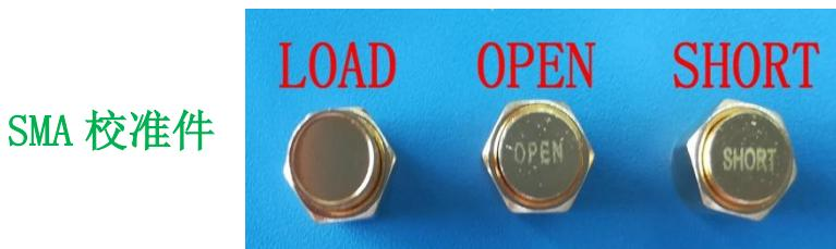
注：[上图三个校准件用户需另行购买](#)（校准件的 SMA 接头为内螺内针），以上三个校准件，常用于反射（S11）校准。
