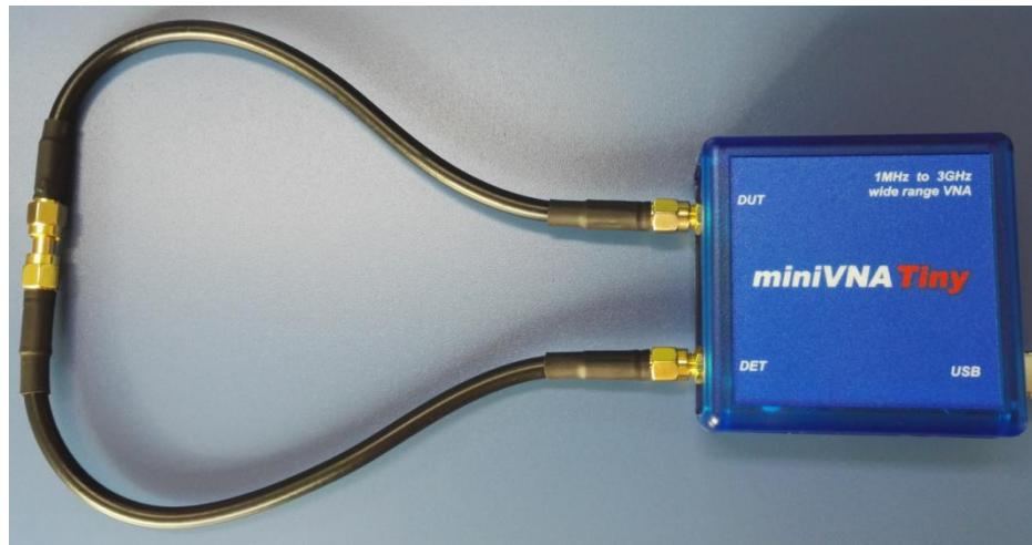
6. 点校准对话框中的 read 闭环, 直至如下图 (直通线校准完成后, 请不要取下或断开连接)
