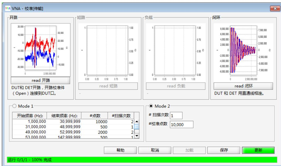
注: 上图中开路和闭环校准曲线每一台 minVNA Tiny 都有区别, 加入不同的配件测量时也不相同, 上图仅供参考。
