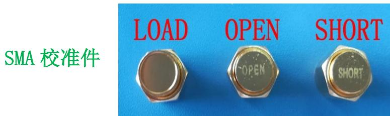
(反射校准需使用以上三个 SMA 校准件，SMA 接头为内螺内针)
