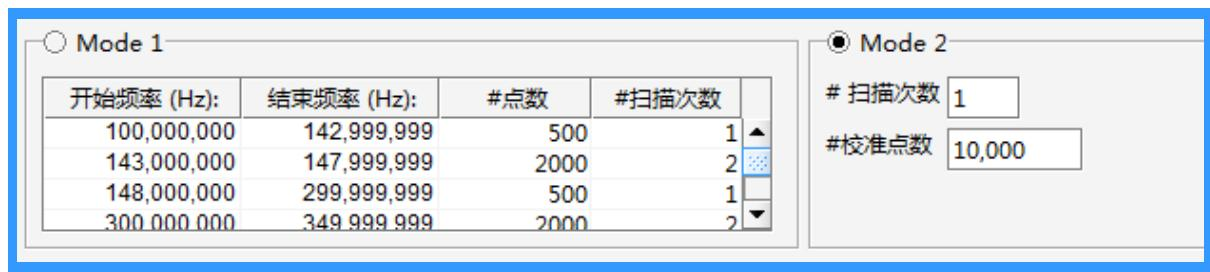
上图中，校准时有两个模式可以选择，默认 Mode2 (Mode1 是对某些频段要求精准校准时使用，Mode1 的频率段和点数相应设定，请参看说明书中的常见问题 2)。扫描次数大于等于 1，小于等于 10 (一般设为 1)；校准点数要求大于等于 100 点，小于等于 20000 点(一般设为 3000 或 10000)；所设点数越多，次数越多，则校准时间越长。
