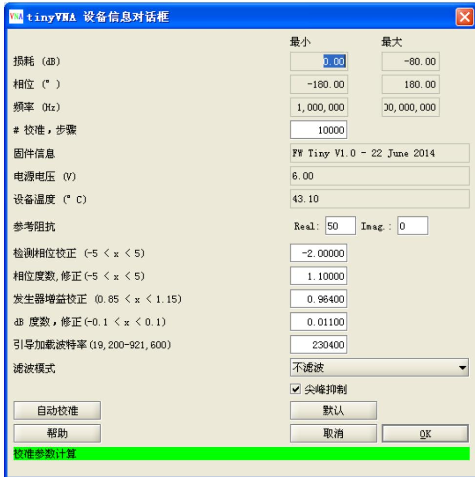
注：上图中二次校准后的修正数据每一台 minVNA Tiny 都有区别（同一台设备每次操作也有区别），上图仅供参考。为确保二次校准数据有效，请在重启软件后，参照[反射校准及测试示例](#)，再做一次反射模式下的开路、短路、负载的校准，然后再进行相应的反射测量。二次校准可以不用每次使用都操作，可以延用上一次的二次校准数据，且二次校准**重要但非必须**。
