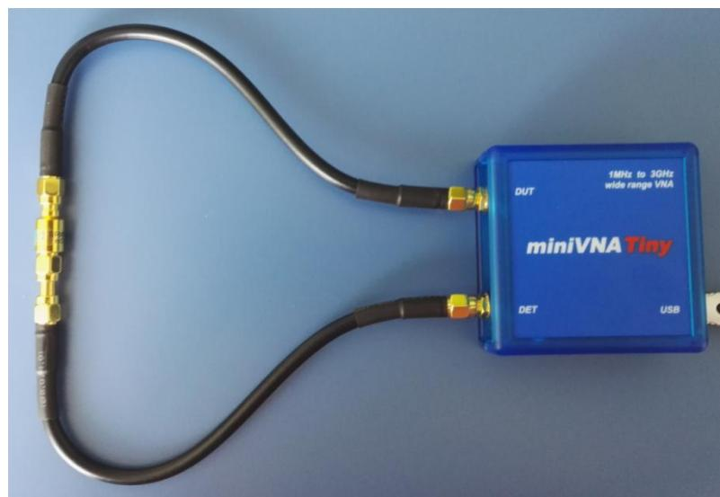
7. 点校准对话框中的 read 闭环，直至如下图（直通线校准完成后，请不要取下或断开连接）
